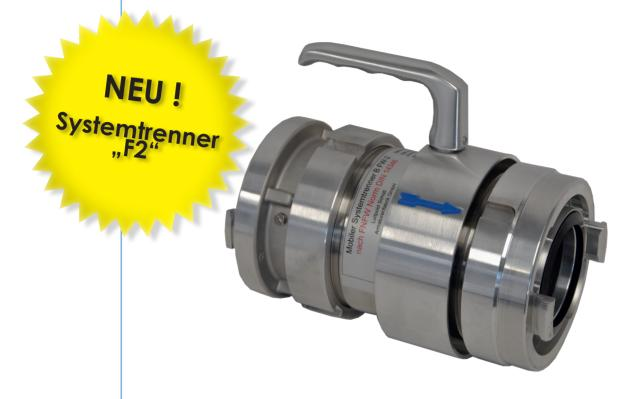
Der Feuerwehr Systemtrenner B-FW Typ "F2" nach DIN 14346 mit einem Durchfluss von 1600 I/min bei einem Druckabfall unter 1 Bar
