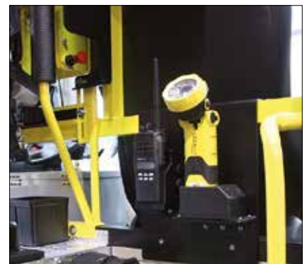
Art.-Nr. B69-7013-A, Ladegerät und Leuchte im Fahrzeug verbaut.
